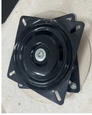
図 1-5-1 菌糸体座具に取り付ける回転盤
