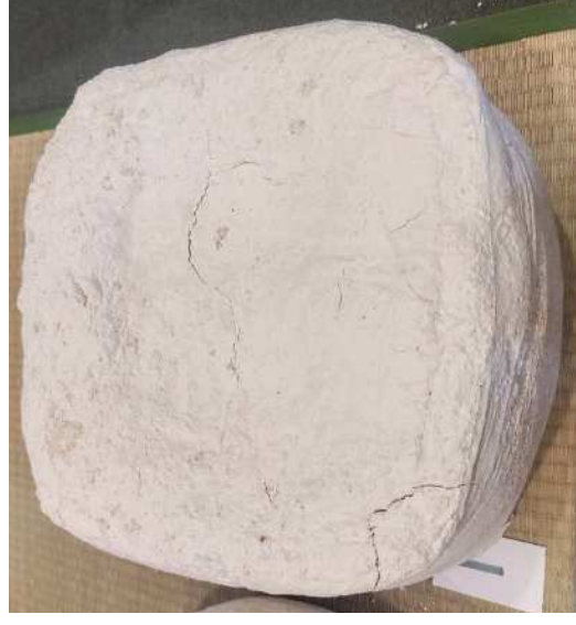
図1-3-4 展示時の反復的な試座による局所的な亀裂の発生
