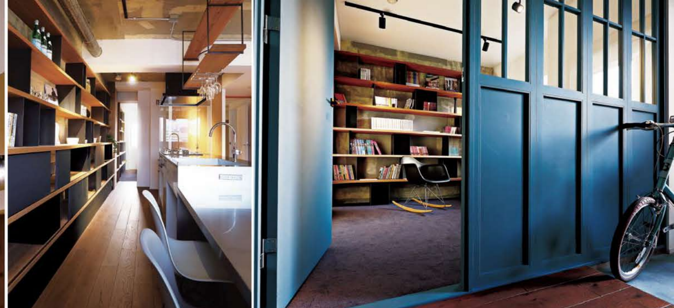
風と光を十分に取り込むことができるように、ライブラリーとキッチンの間にあった間仕切り壁を無くし、引戸に設計。ライブラリーの建具はオリジナルで製作し、一部ガラス張りにする事で玄関からの光を取り込めるようにした。
