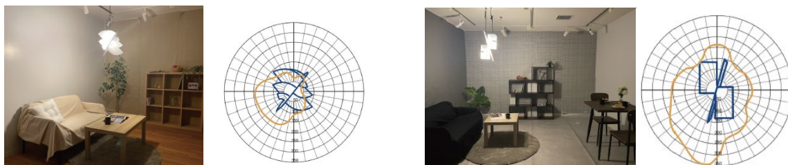
図7 1 灯で 2 種類の配光をもつリビング用ペンダント照明とその配光曲線
