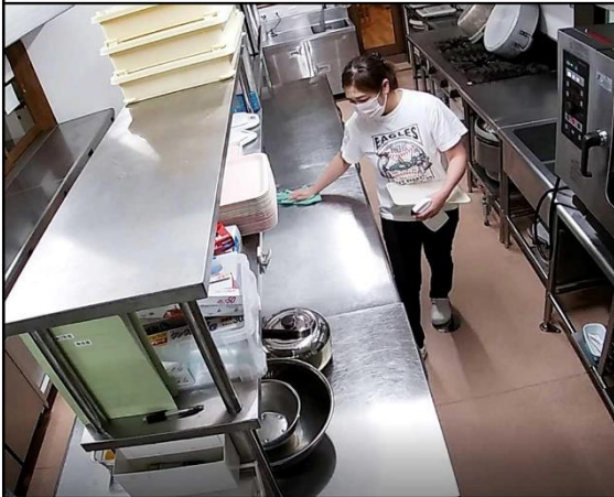
8 ふきんで台を拭く 作業台の間口は3台の連結により3.6mと長い。各台のつな ぎ目は同面でしっかり接着してあるため、台を拭く際にも 凹凸がなく掃除でき、衛生的である。
